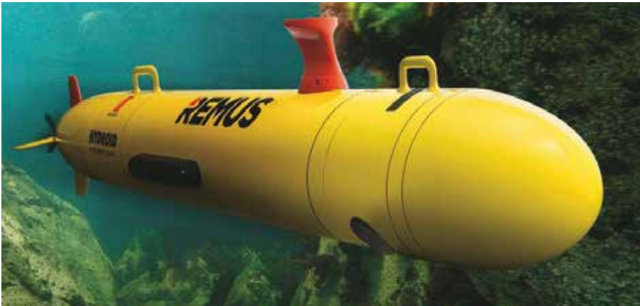
Die frei programmierbare AUV-Drohne „Remus“
