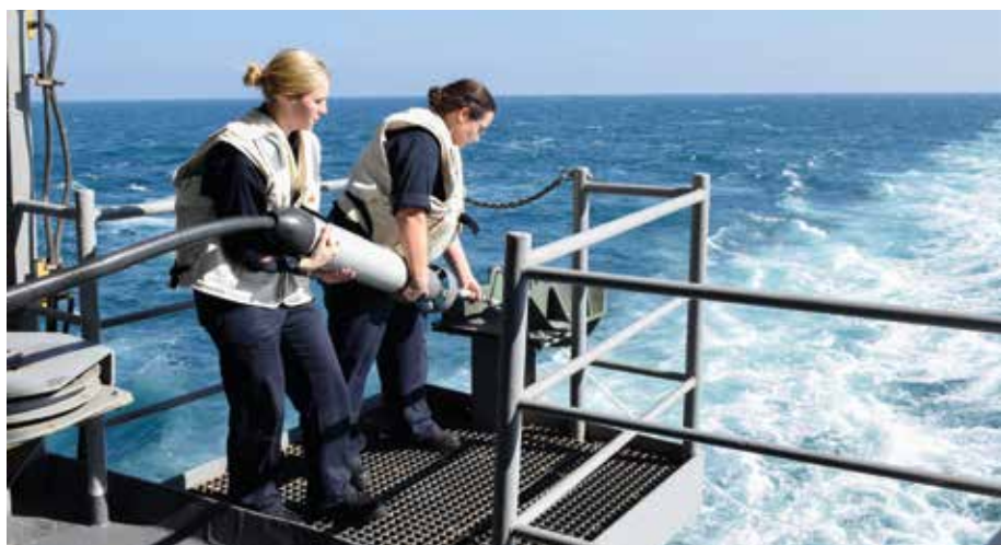
Mit Täuschkörpern sollen Torpedos vom eigentlichen Ziel abgelenkt werden
