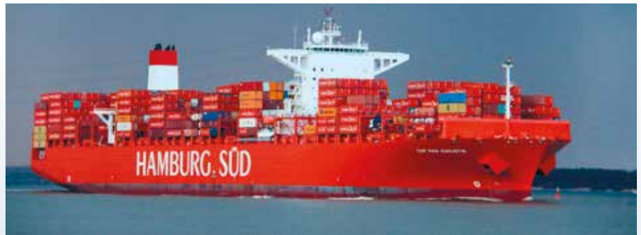
Die neue CAP SAN-Klasse – hier die CAP SAN AUGUSTIN verfügt über Steplätze von jeweils 9.600 TEU, darunter eine hohe Zahl mit Kühlcontaineranschlüssen
