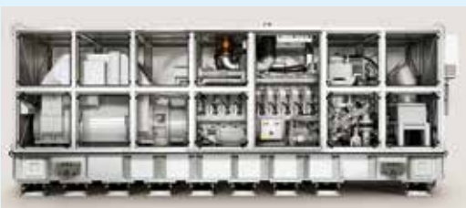
MTU Typ 20V 4000 M53B in einer Schallkapsel (Foto: Tognum)
