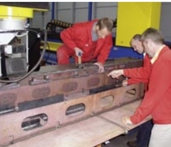
Überprüfung einer lasergeschweißten Struktur
