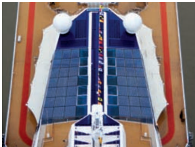
Auf den Glasflächen installierte Solarmodule tragen zu einer außergewöhnlichen Energieeffizienz der „Celebrity Equinox“ bei
