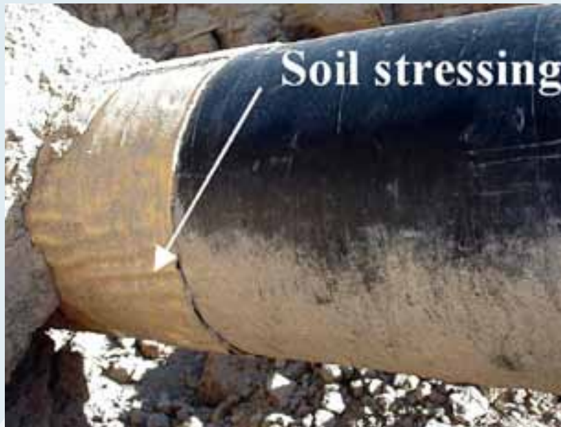
ABBILDUNG 7. Gegen Belastungen durchs Erdreich bieten mit Heißklebern aufgebrachte PP-Manschetten besseren Schutz.
