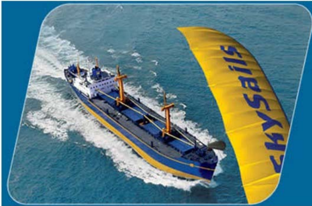
Abbildung 3: Beispiel für eine Drachen-Besegelung Ex SKYSAILS Homepage http://www.skysails.de
