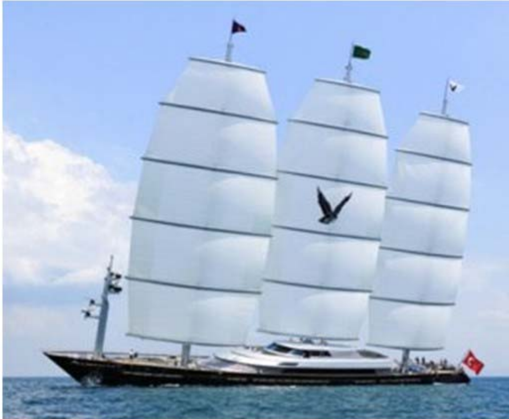
Abbildung 5: Beispiel für eine Dynarigg- Besegelung (System Prölss) SY „Maltese Falcon“ Ex Maltese Falcon Homepage, 2007
