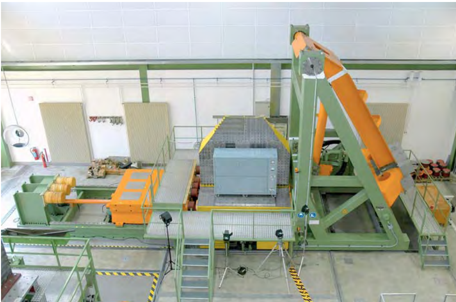
Prüfanlage zur Untersuchung der Auswirkung vertikaler Schwingungen
