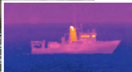
Großes Bild: Minensuchboot im Erdmagnetfeld-Simulator. Kleines Bild: Messung der Infrarot-Signatur eines Mehrzweckbootes
