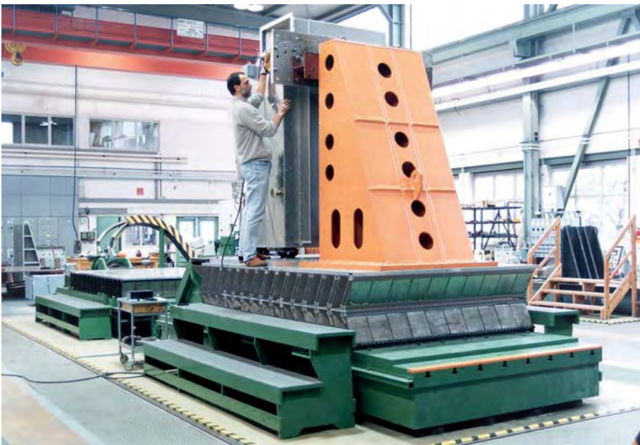
Prüfanlage zur Untersuchung der Auswirkung vertikaler Schwingungen
