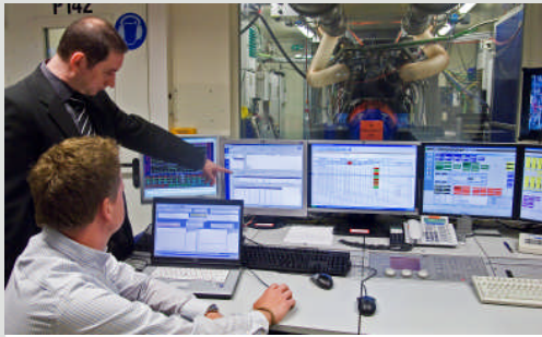
Das Computerprogramm Cameo hilft bei der Motorenabstimmung am Prüfstand.
