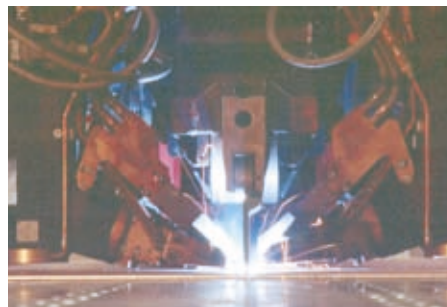
Lasertechnik im Schiffbau ermöglicht Produktivitätssteigerungen und Qualitätsverbesserungen. Foto: TKMS
