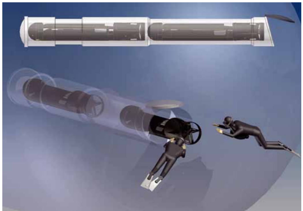
Lagerung und Verbringung von 2 SDV aus einem Torpedorohr
