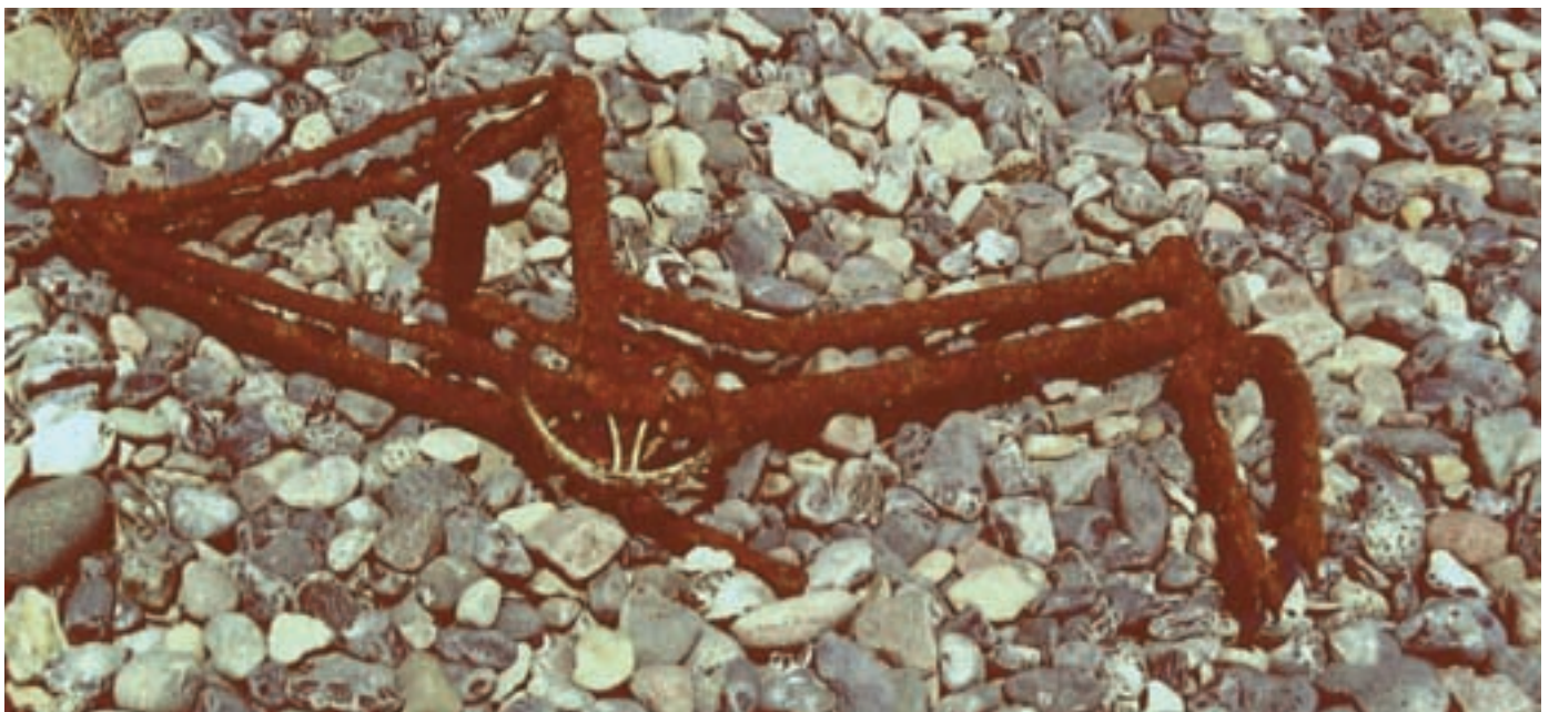
Abb. 1: Stahlrahmen eines Fahrrades, der im Anschluss an das finale Versagen der Beschichtung in die thermodynamisch stabilere Form des Eisens durch fortwährenden Witterungseinfluss im Tidenbereich der Ostsee umgewandelt worden ist
