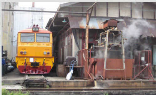
Eine Lokomotive in Thailand beim Lasttest nach erfolgreicher Remotorisierung mit MTU-Motoren.
